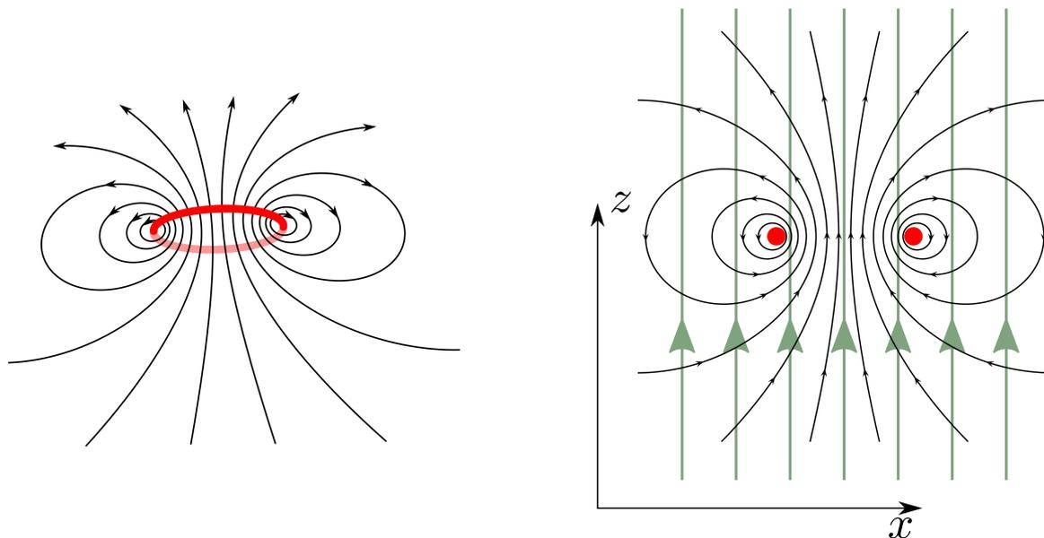
图 6：圆形涡旋环路的流速度场和用于计算  $q(x,y)$  的积分路径 (绿色)
