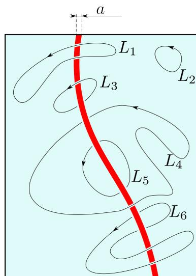
图 1: 超流体 (浅蓝色) 中的涡旋丝 (红色)。速度沿路径  $L_1$ ,  $L_2$ ,  $L_5$ , 和  $L_6$  的旋度为零, 但沿  $L_3$  和  $L_4$  的旋度等于  $\pm 2\pi\kappa$ 。注意沿  $L_3$  和  $L_4$  的旋度方向相反。
