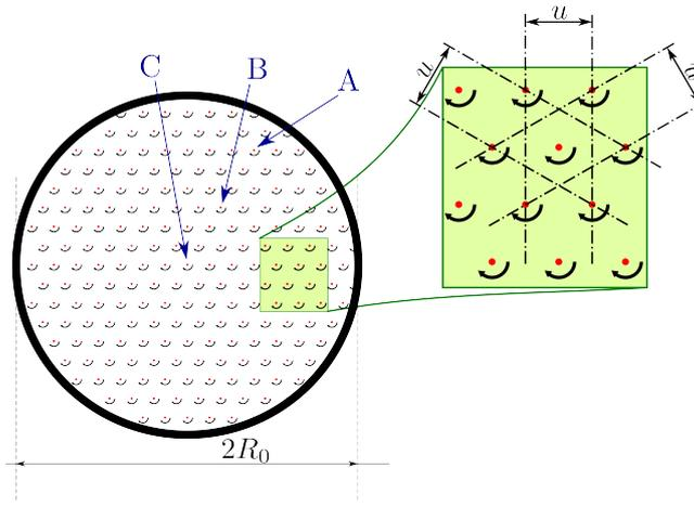
图 5: 烧杯中的三角形栅格分布的涡旋。此为俯视图。
