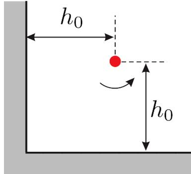
图 12: 放置在直角器壁附近的直涡旋丝。
