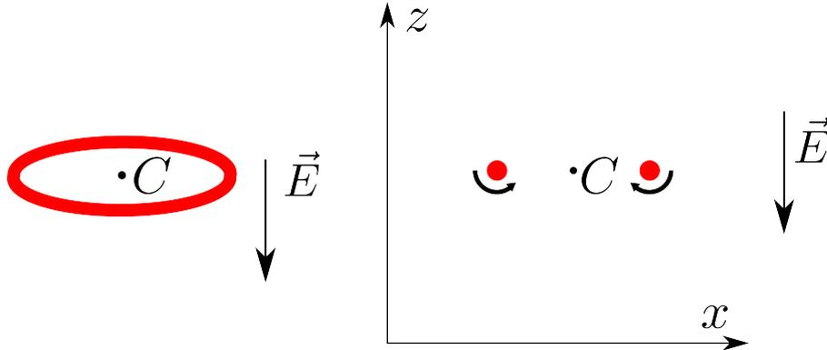
图 10: (左) 均匀电场中的涡旋环。(右) 环的截面。
